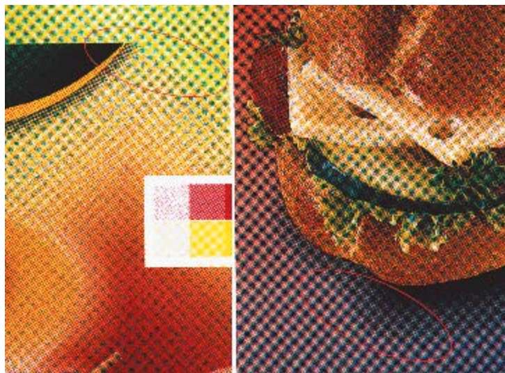
Vyznačené oblasti demonstrují simulaci minimálního tisknutelného bodu; v datech je v obou případech zcela plynulý přechod, na reálném výtisku se objeví skoková hrana (sken nátisku)
