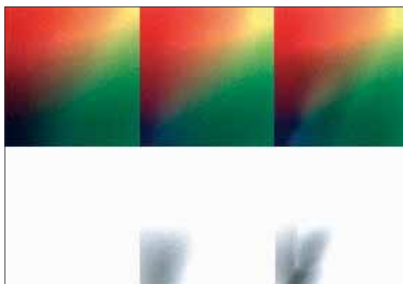
Ukázka separace z RGB do CMYK. Levý čtverec RGB, prostřední po separaci v ColorServeru, pravý čtverec po separaci v Photoshopu přes ICC profily. Ve spodní části příslušné černé kanály (sken z materiálů Swel)
